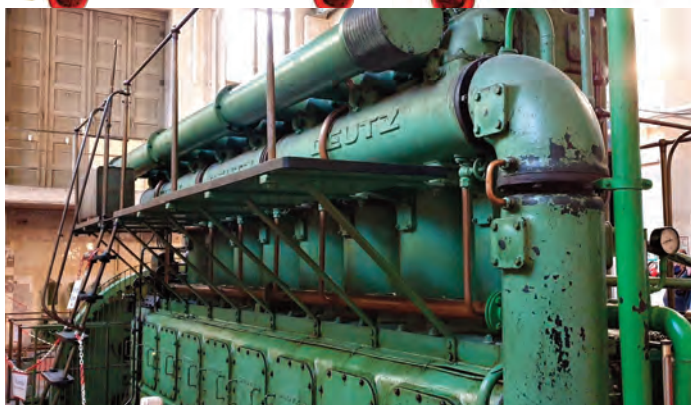
Immer noch arbeitsfähig: der 1000 PS Dieselmotor der Firma Deutz AG.
